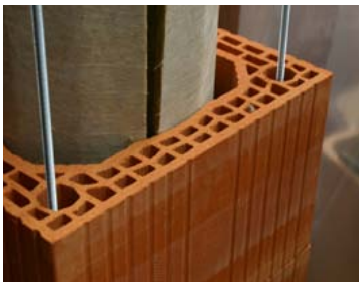
Osazení zpevňující výztuže
